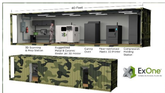
Abbildung 1: Konzeptdarstellung einer mobilen 3D Drucklösung für militärische Anwendungen (3D Grenzenlos, 2021)
