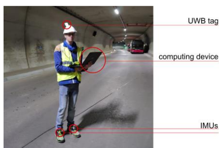
Abbildung 23: Erste Tests der unterschiedlichen Sensoren im Straßentunnel des „Zentrum am Berg“
