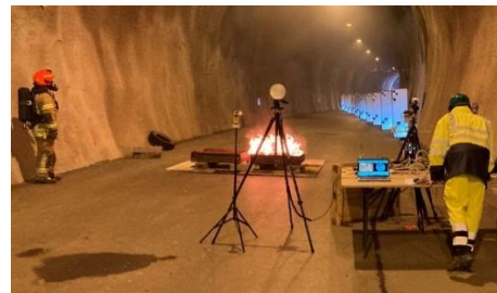
Abbildung 2: Tests der Sensorik für den semi-autonomen Roboter unter realen Rauchbedingungen (ZaB)
