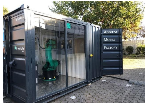
Abbildung 2: Demonstrator für eine containerbasierte mobile 3D Drucklösung (AMF: Additive Mobile Factory®)
